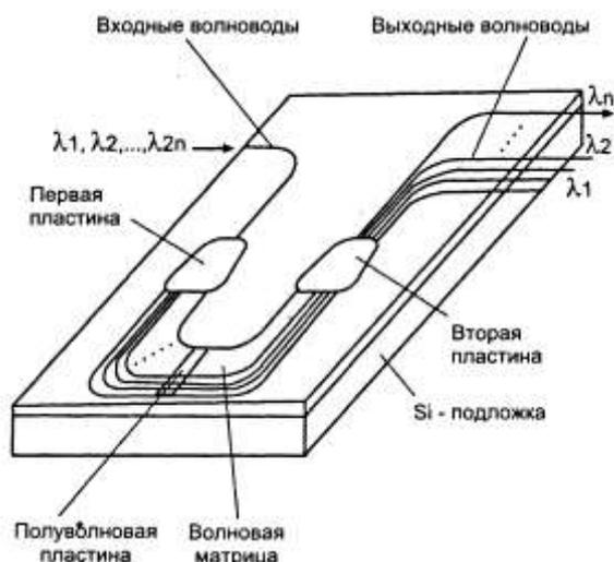
Рис. 16.2. Схема устройства волноводного мультиплексора
