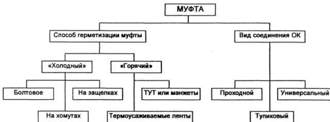
Рис. 14.2 Классификация конструкции по способу герметизации и виду соединения
