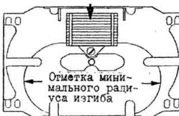
Рис. 14.4. Кассеты муфты серии USCO 4-6, ОАО «Межгорсвязьстрой» +RXS
